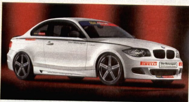
6 Zylinder, 3 Liter Hubraum, Direkteinspritzung und mehr als 360 PS: Der Motorwelt-BMW 135i für das 24h-Rennen in einer Modellzeichnung
