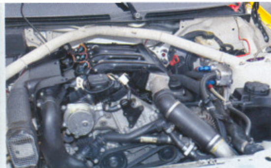
Der Zweiliter-Vierzylinder-Diesel stammt aus einem BMW 320d der Baureihe E90
